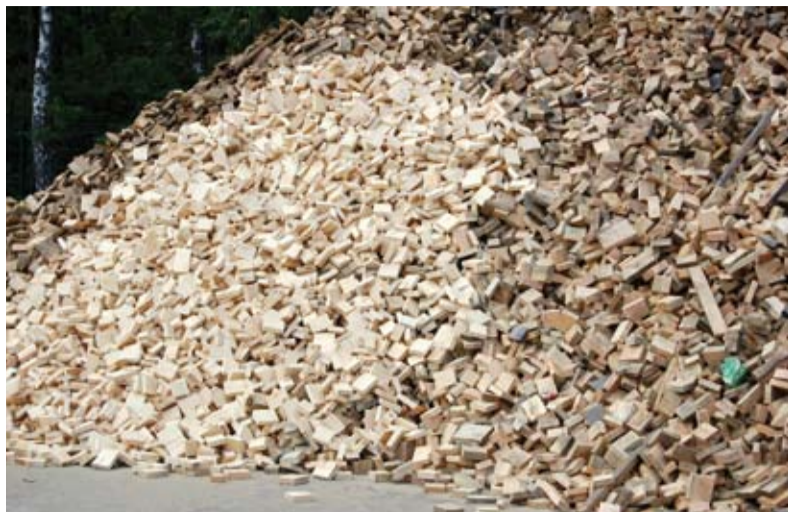
Teraz można efektywnie zagospodarować odcięte na optymalizerkach kawałki listew zawierające wady.
